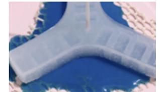
Fixation d'une couche de silicone pour fermer le moule.
