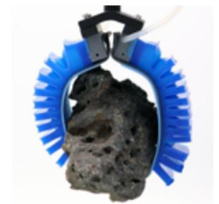
Soft robotic gripper par des chercheurs de l'UC San Diego (Source: <https://rdworldonline.com/gecko-inspired-adhesives-help-soft-robotic-fingers-get-a-better-grip/>)
